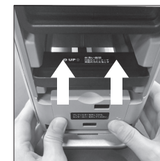
② 大気センサーカバーを上をスライドさせるとカバーが外れます。
