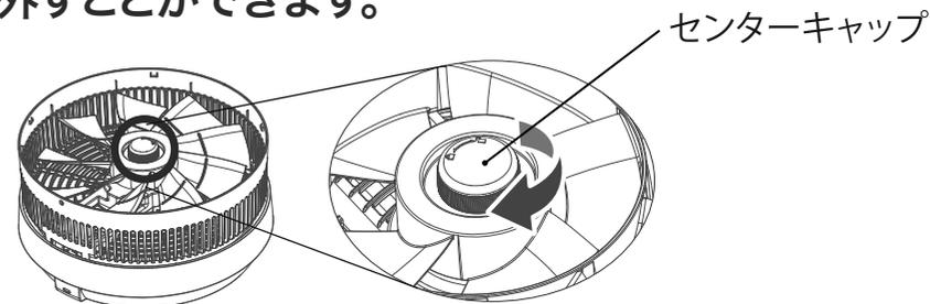
取り外したファンは、食器用洗剤などを使って水洗いします。お手入れ後は、完全に乾燥した状態でファンを取り付けてください。
